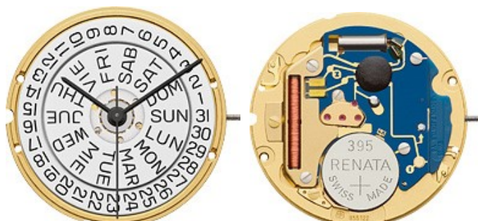
ETA 955.122 (955.121 - 955.124) 11½''' SCDD Ø 25,60 mm, H 3,00 mm H3 = hoogte uurrad 1,55 mm Wijzermaten: 1,20/0,70/0,20
