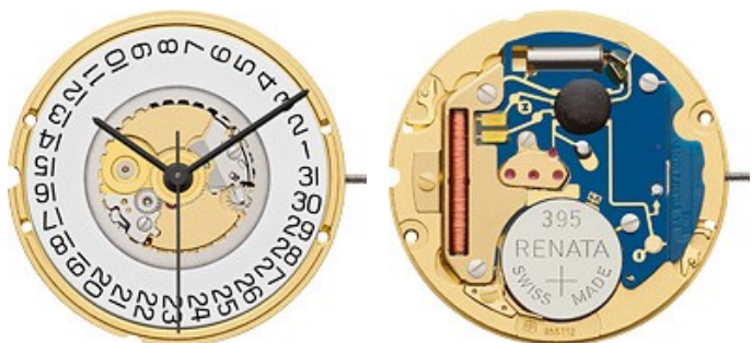
ETA 955.112 (955.111 - 955.114) 11½''' met of zonder SC (datumvenster 3 uur of 6 uur) Ø 25,60 mm, H 2,50 mm H0 = hoogte uurrad 0,89 mm H1 = hoogte uurrad 1,06 mm H3 = hoogte uurrad 1,55 mm Wijzermaten: 1,20/0,70/0,20
