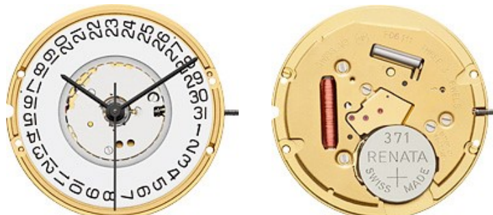
ETA F06.111 11½''' met of zonder SC (datumvenster 3 uur of 6 uur) Ø 25,60 mm, H 2,50 mm H0 = hoogte uurrad 0,89 mm H1 = hoogte uurrad 1,06 mm H3 = hoogte uurrad 1,55 mm Wijzermaten: 1,20/0,70/0,20
