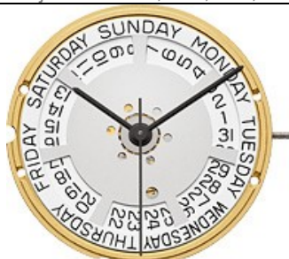
ETA 955.132 (955.131) 11½''' SCD3D12 Ø 25,60 mm. H 3,00 mm H3 = hoogte uurrad 1,55 mm Wijzermaten: 1,20/0,70/0,20
