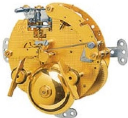
W 130-677 8-daags, veren, Ø 90 mm, balans inw. hoogte 21/18 mm belslag, 1 bel op achterplaat 46 mm achteropwinding met 2 geschroefde wegklapbare sleutels
